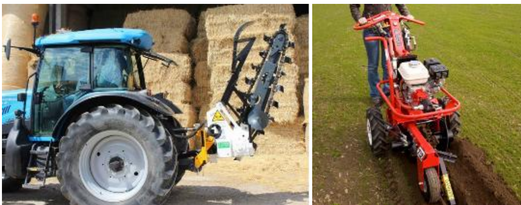
Photo 21. Exemple de trancheuse thermique : sur prise de force tracteur à gauche, et autotracté à droite.
